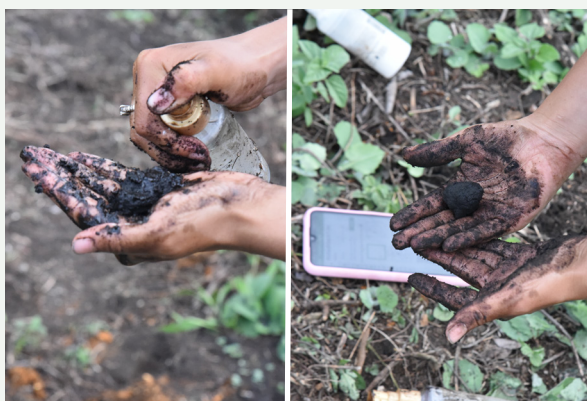
Figura 14. Humedeciendo el suelo y realizando bola
