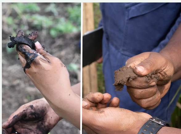
Figura 15. Haciendo cinta con la muestra de suelo
