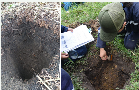
Figura 11. Limpieza de perfil del suelo
