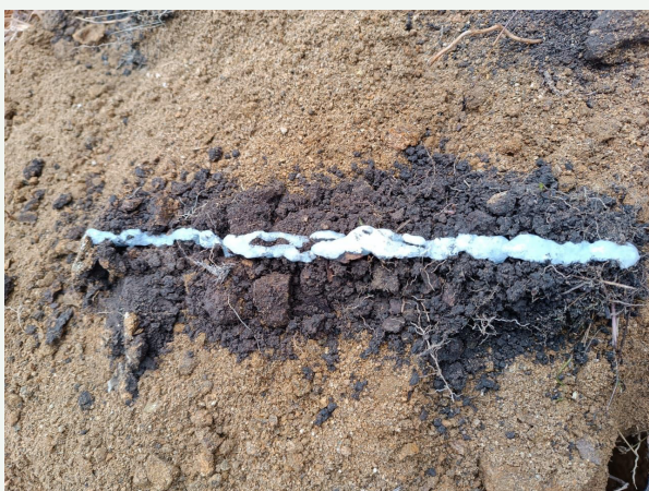
Figura 27. Alta efervescencia en muestra del perfil de suelo
