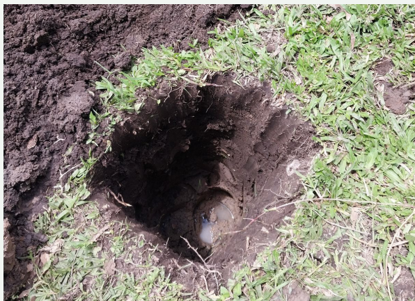
Figura 9. Ejemplo de nivel del agua en una calicata
