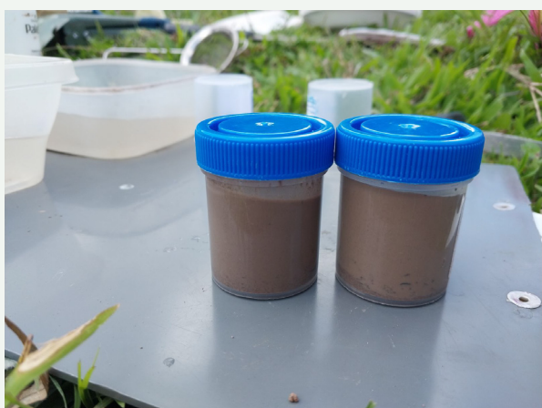
Figura 23. Muestra de suelo en suspensión para medir pH
