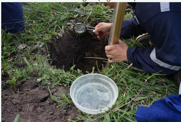
Figura 18. Tazón con agua para sumergir la muestra de agregados del suelo
