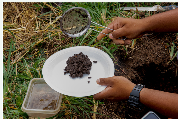
Figura 21. Muestra de agregados después de la sumersión en agua
