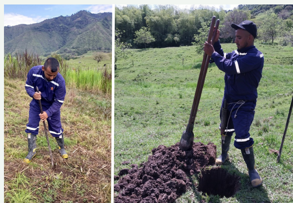
Figura 7. Apertura de la calicata con barra
