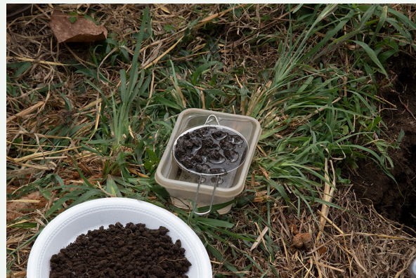
Figura 20. Muestra de suelo sumergida en agua para evaluar la estabilidad de agregados
