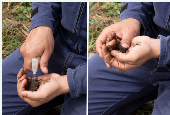
Figura 16. Sensación al tacto de la muestra de suelo
