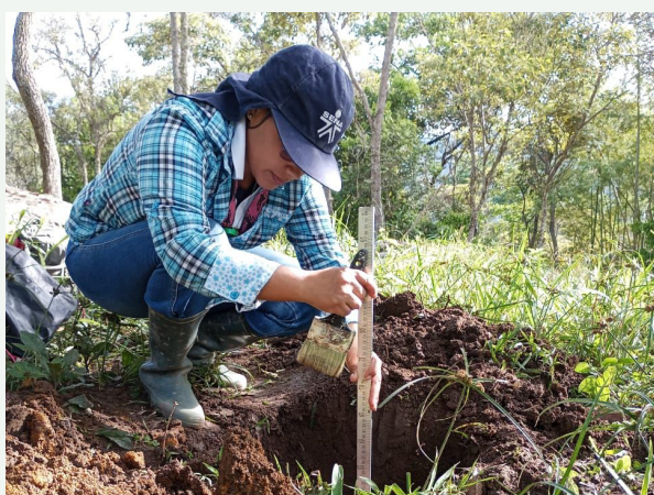
Figura 10. Medición de profundidad efectiva
