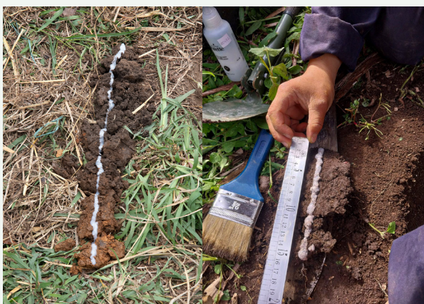
Figura 28. Baja efervescencia en muestra del perfil de suelo
